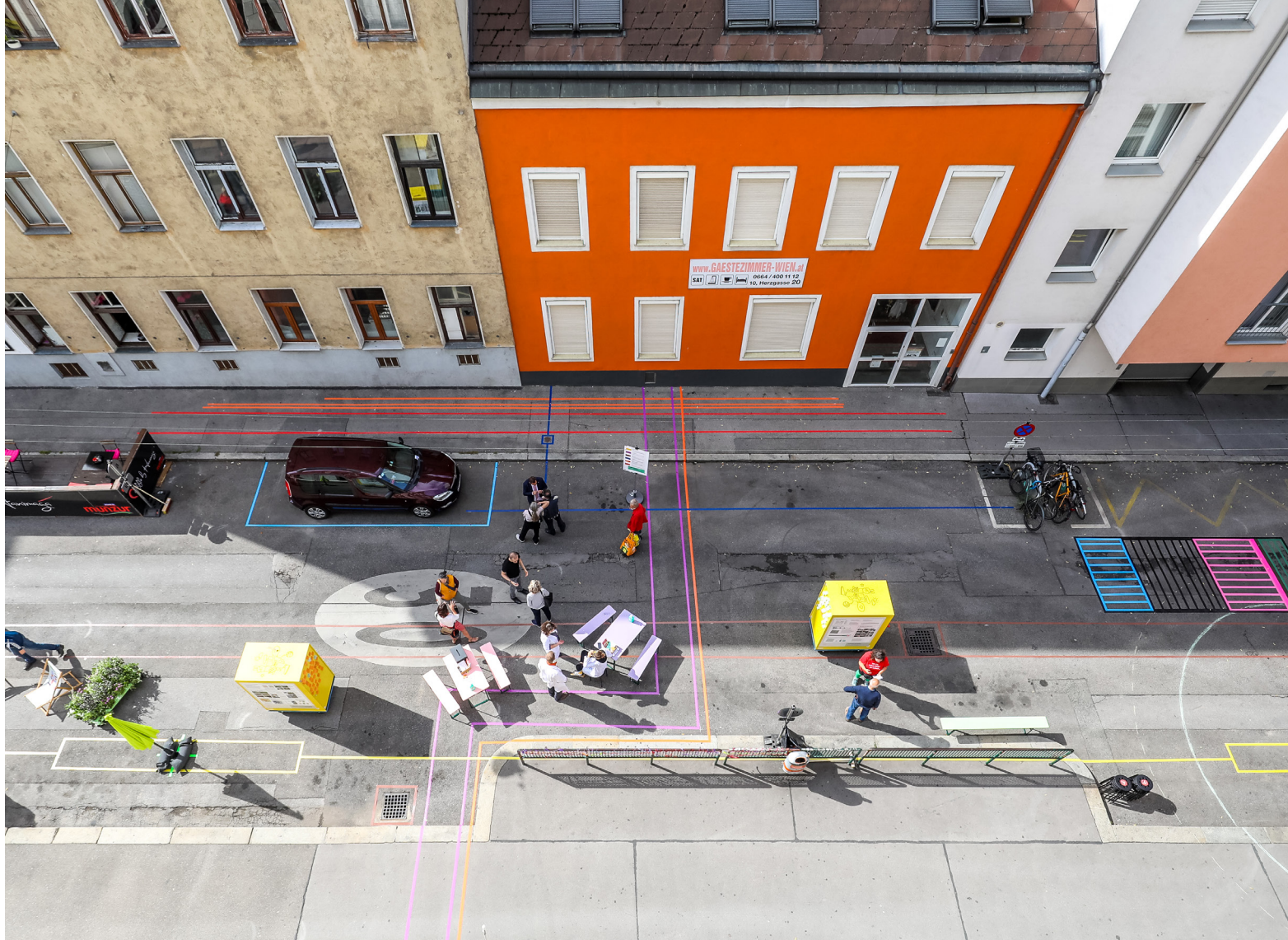
Straßenlabor von oben: Die bunten Linien auf der Straße zeigen, wo Einbauten verlaufen und somit Baumpflanzungen nicht umsetzbar sind.
