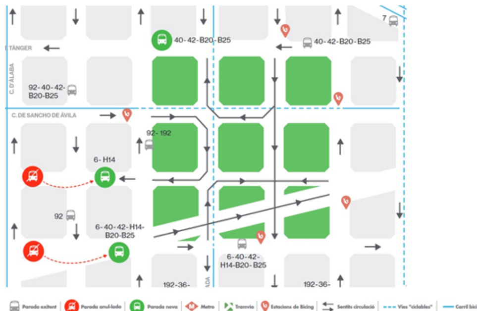
Abbildung 13: Geänderte Verkehrsorganisation für den Superblock El Poblenou. Quelle: Ajuntament de Barcelona.
