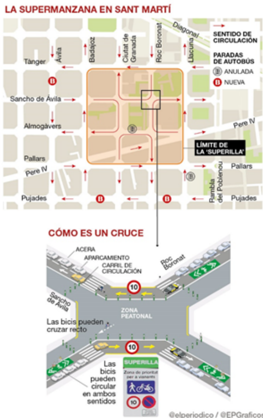
Abbildung 10: Verkehrslösung mit Diagonalsperre in der Supermanzana Poblenou. Quelle: El Periodico .
