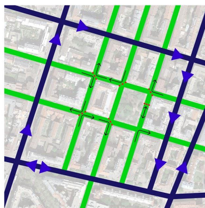
Abbildung 24: Schemata für Varianten der Organisation des KFZ-Verkehrs - links: hierarchieloses Einbahnstraßennetz; Mitte und rechts: Superblock, Bündelung des Durchzugsverkehrs auf umliegenden Hauptverkehrsstraßen (rot), verkehrsberuhigte Schleifen zur lokalen Erreichbarkeit (blau); rechts: Variante eines Superblocks mit reduzierter Kfz-Erreichbarkeit z.B. rund um einen Park. (Quelle: eigene Darstellung.)
