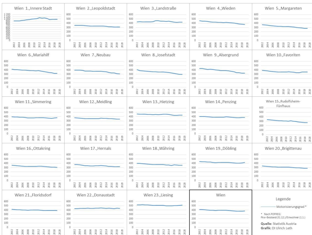
Abbildung 5: Entwicklung des Motorisierungsgrads Pkw (Pkw und Kombi / 1.000 Einwohner) nach Wiener Bezirken seit 2002. (Quelle: eigene Darstellung auf Basis Statistik Austria.)
