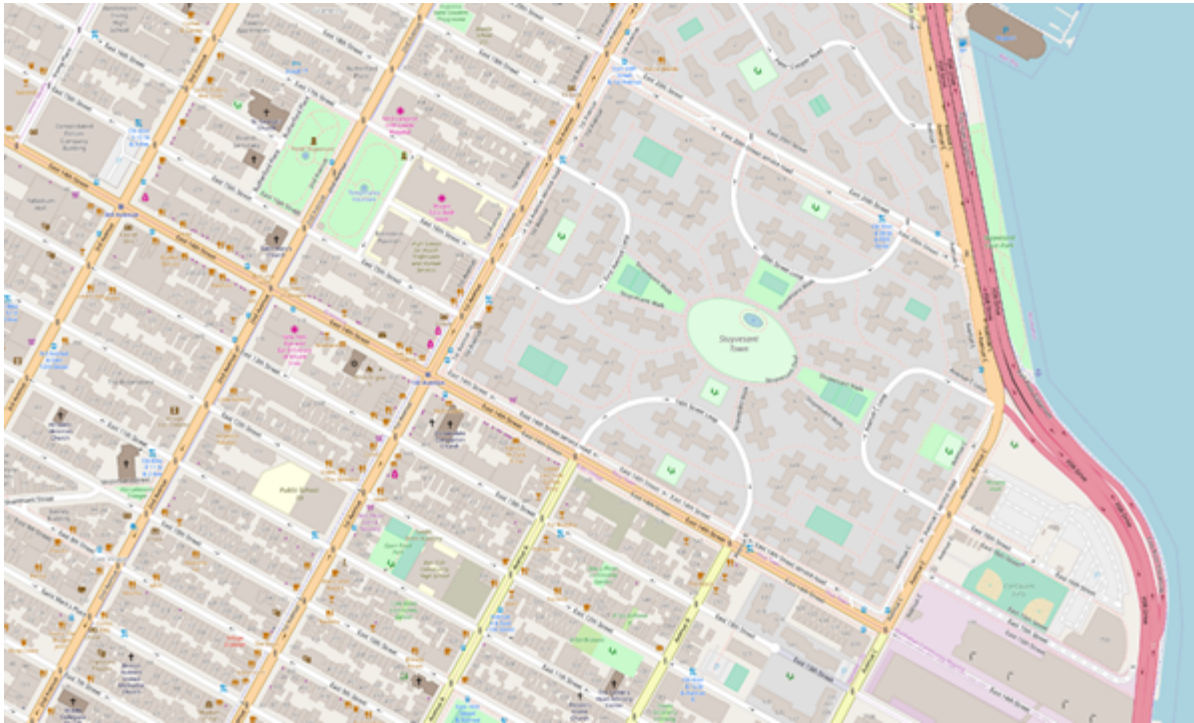
Abbildung 20: Kartenansicht von Stuyvesant-Town. Gut zu erkennen ist, wie das ansonsten in Manhattan dominierende Grid durchbrochen wird und die Loop-Streets zwar Erschließungs- aber keinen Durchzugsverkehr erlauben. Quelle: Open Street Map.
